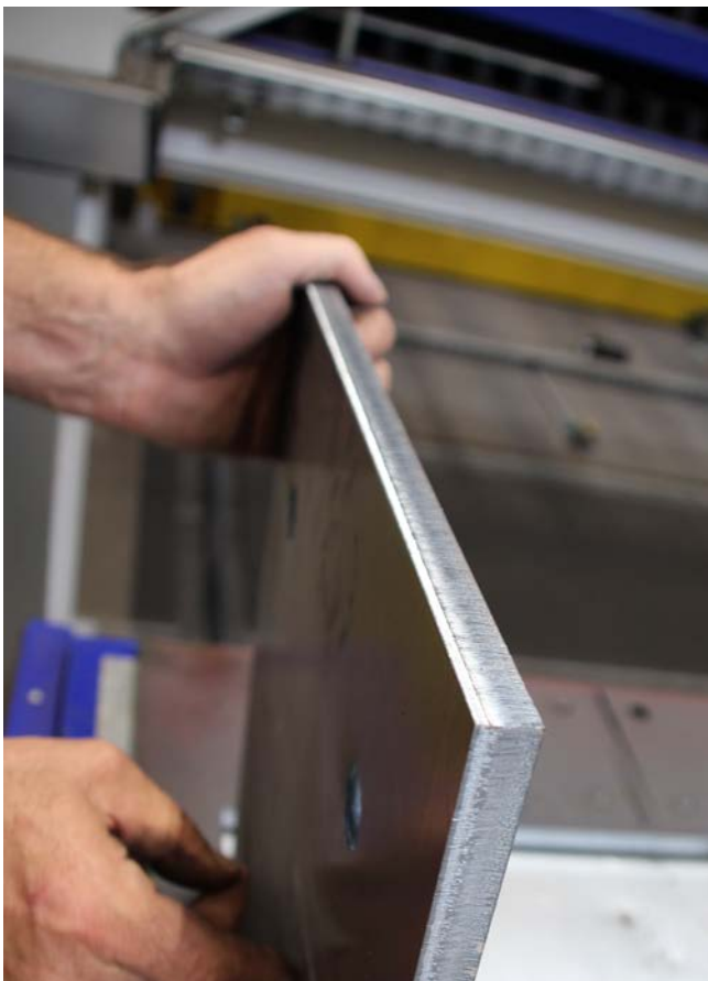
Die Schnittqualität mit der Optiplex 3015 Fiber III kann sich sehen lassen. Bei der Hopf GmbH ist man damit absolut zufrieden.
